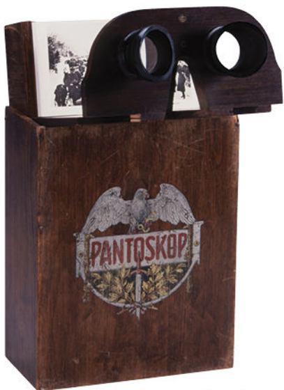
Pantoskop fantázianevű, papírképekhez készített sztereonéző szerkezet Magyar Nemzeti Múzeum gyűjteménye
